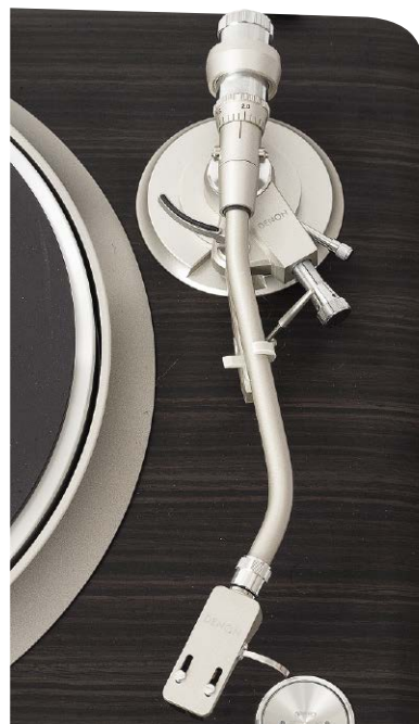
Blokada i dźwignia regulacji wysokości ramienia to ciekawe „historyczne” rozwiązanie Denona.
